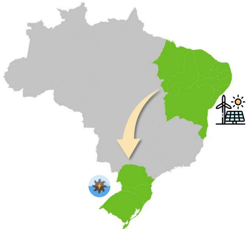
Em função das grandes distâncias envolvidas (2.000 a 3.000 km), soluções em corrente contínua em alta tensão (HVDC) mostram-se atrativas para a integração e escoamento eficiente dos excedentes de geração regionais, bem como para agregar controlabilidade e flexibilidade operativa para a rede de transmissão. Estão em análise alternativas baseadas nas tecnologias **LCC (Line-Commutated Converter)** e **VSC (Voltage Source Converter)**.
