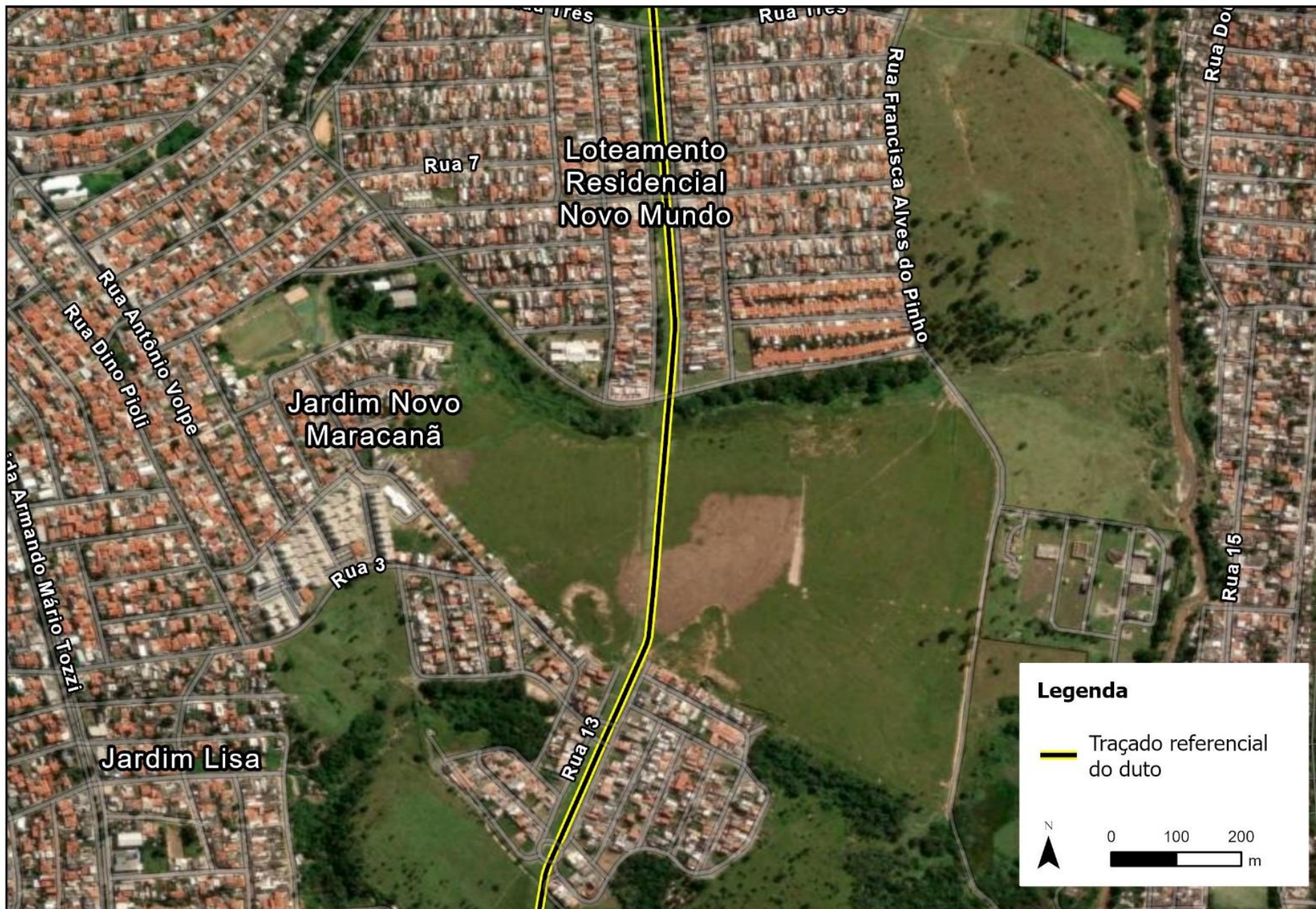
Figura 4 – Trechos em que a faixa de servidão cruza com loteamentos, em Campinas/SP
