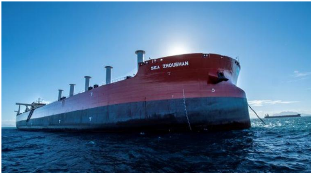
Figura 19 - Navio mineraleiro da Vale, equipado com um sistema de velas rotativas [38]
