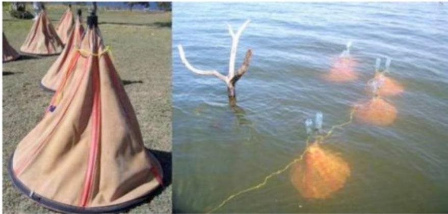
**Figura 4 - Detalhe de funis invertidos para medição de bolhas**
