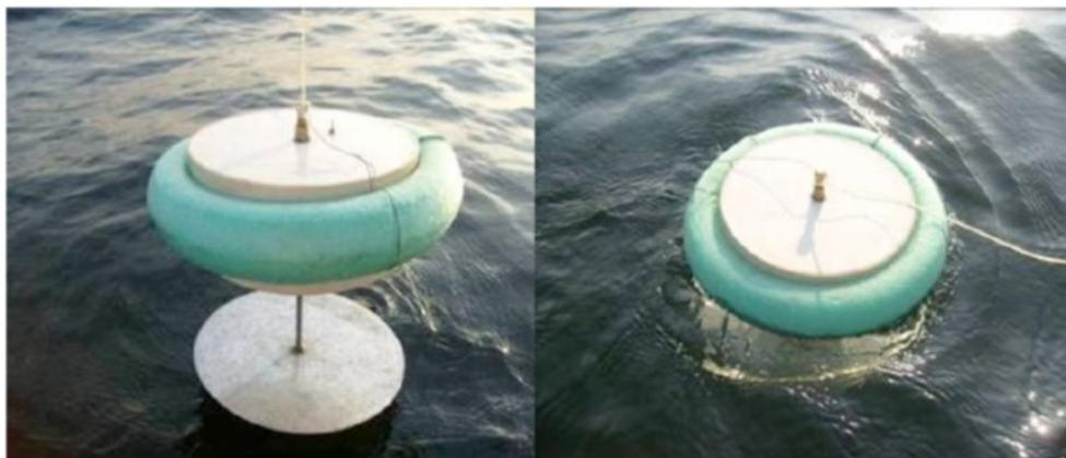
**Figura 3 – Detalhe de uma câmara de difusão (1000 ml)**
