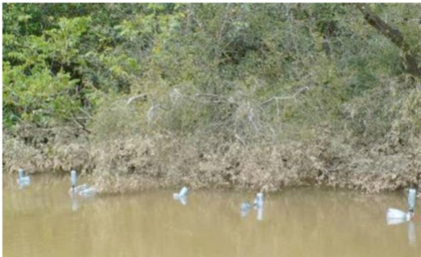
**Figura 5 – Medição de bolhas com funis invertidos em rios, próximo à margem**
