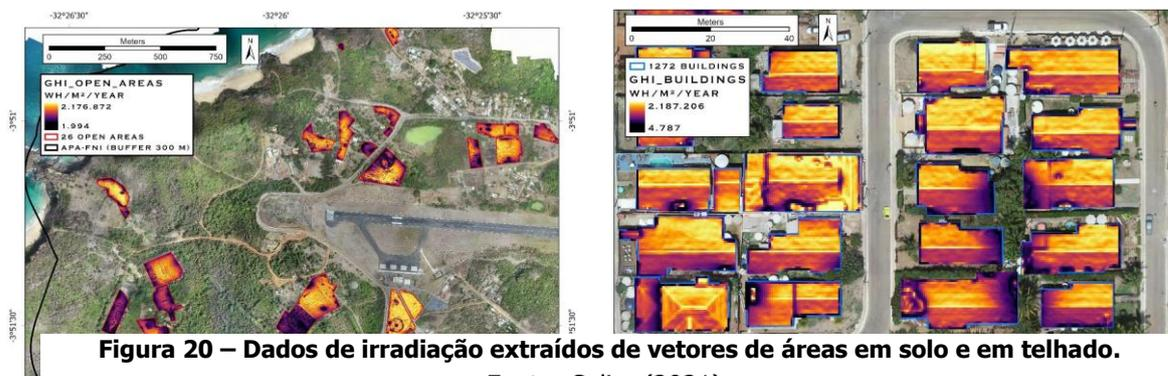
**Figura 20 – Dados de irradiação extraídos de vetores de áreas em solo e em telhado.**
