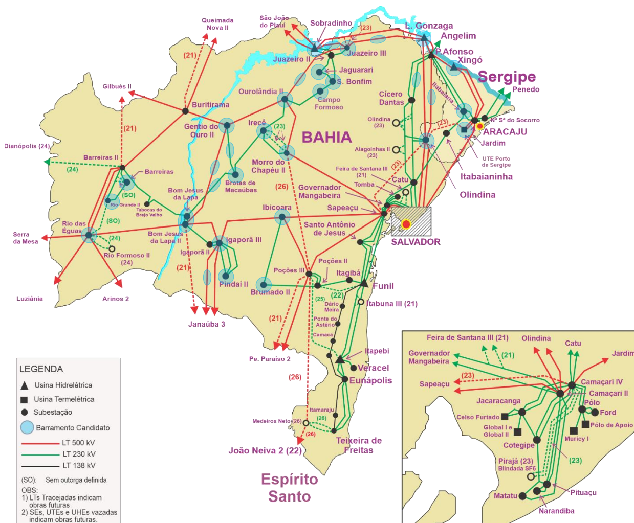
Figura 8-9: Sistema elétrico do estado da Bahia
