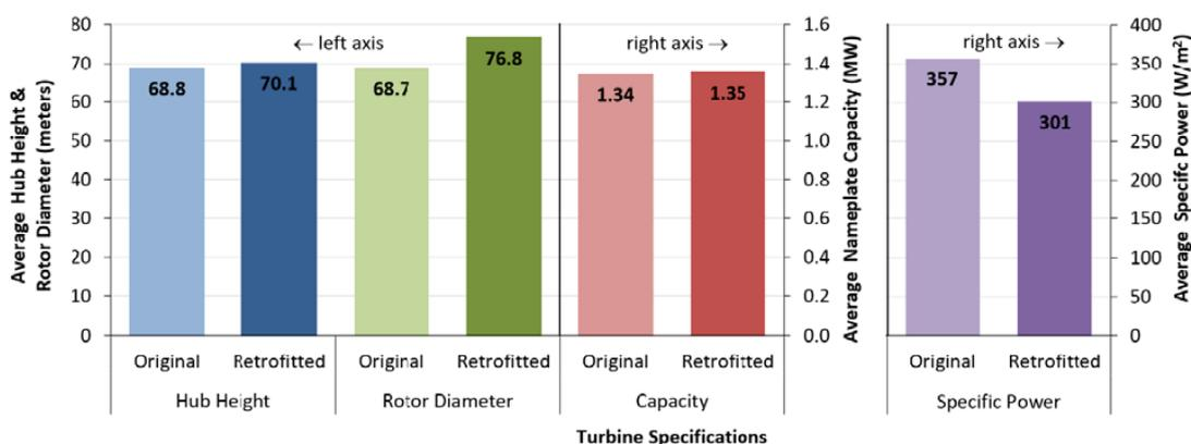
**Figura 3 – Alterações médias das especificações de turbinas parcialmente repotenciadas entre 2017 e 2018.** Fontes: AWEA Wind IQ (2019); USWTDB (2019) *apud* Wiser & Bolinger (2019).
