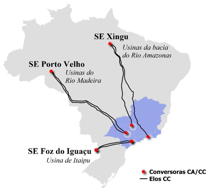
**Figura 1-1 - Conexão de bipolos em corrente contínua no sistema São Paulo e vizinhança**
