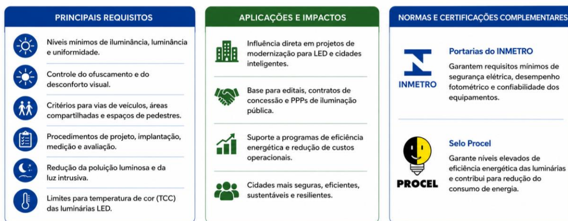
Figura 16. Síntese dos principais requisitos da ABNT NBR 5101:2024.
