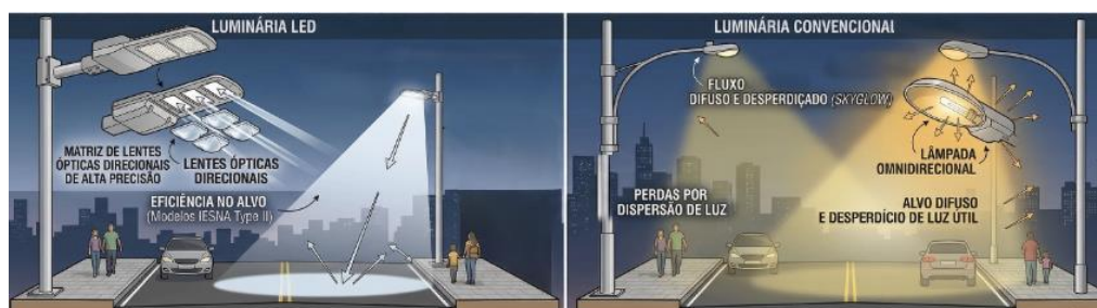
Figura 14. Feixe Luminoso LED X Refletores.
