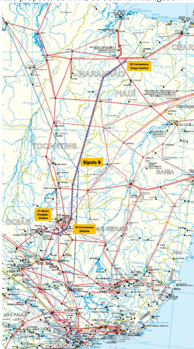
Figura 16. Diagrama esquemático da expansão proposta ao MME do sistema interligado N-NE-SE-CO por novo elo em corrente contínua
