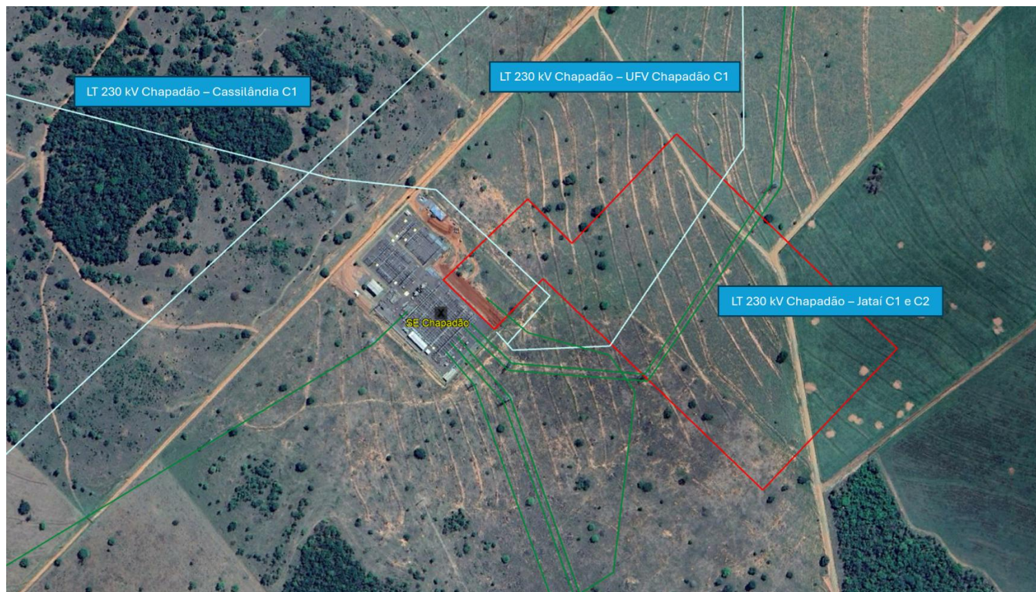
Figura 3-4 Adequações no entorno da SE Chapadão.
