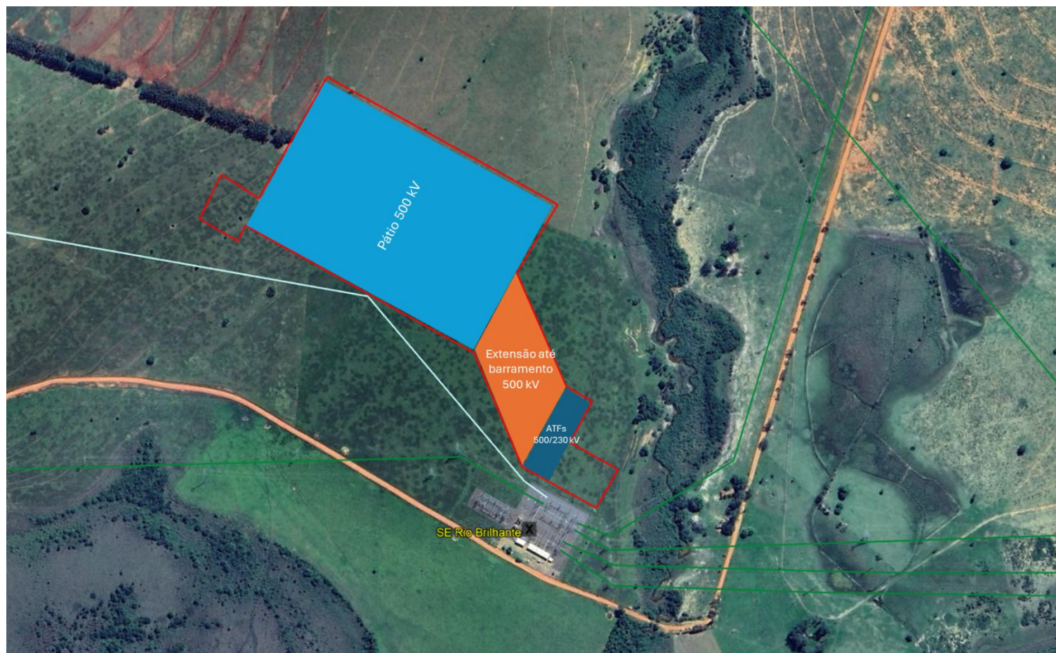
Figura 3-2 Adequações no entorno da SE Rio Brilhante.
