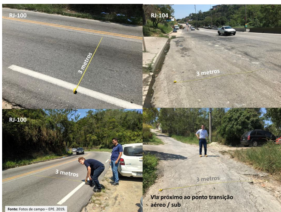
Figura 8 – Medições de largura das faixas nas rodovias RJ-100, RJ-104 e via próximo ao ponto proposto de transição LT aérea / LT subterrânea
