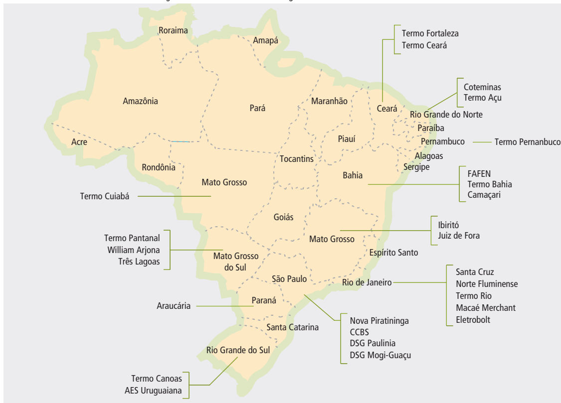
Figura 6 – Usinas termelétricas a gás natural instaladas no Brasil
