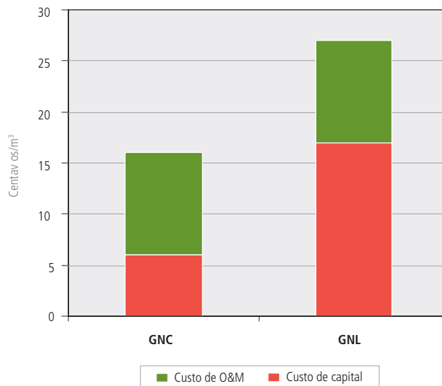
Figura 6 – Comparação do peso dos custos de capital e de O&M em projetos de oferta a partir de GNC e GNL
