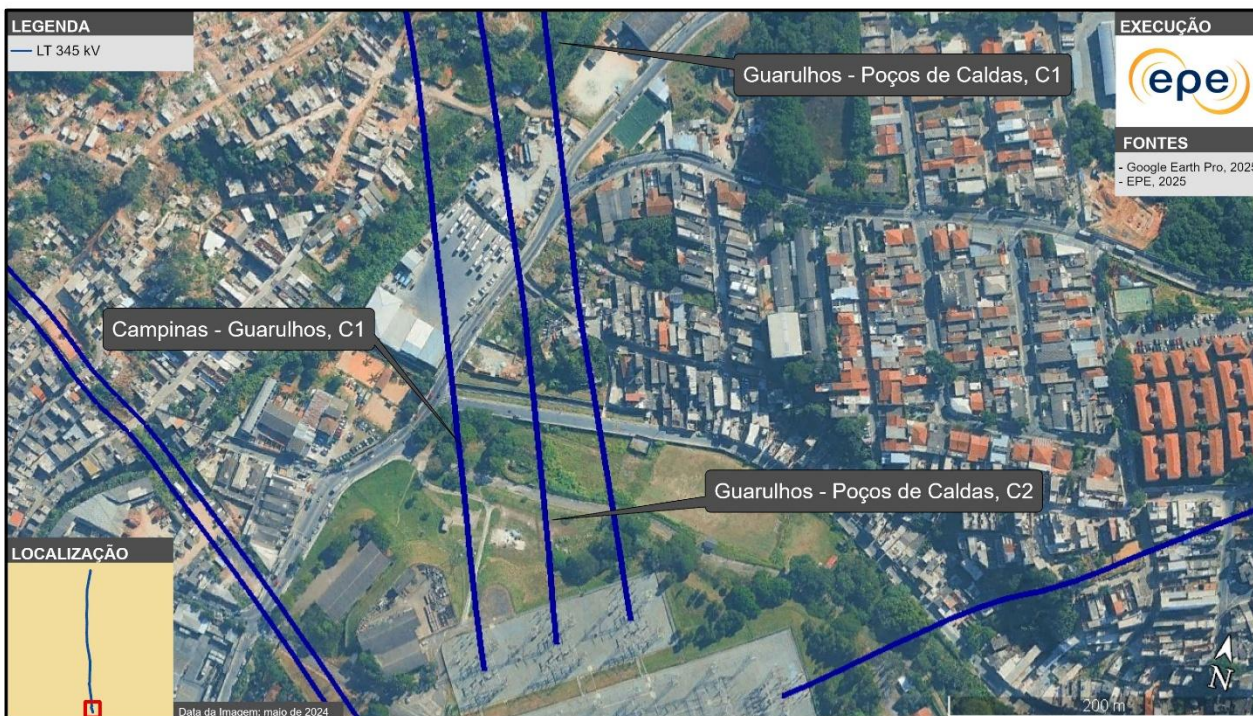
Figura 13 – Entorno da SE Guarulhos com ocupações nas faixas de servidão das LT 345 kV Guarulhos - Poços de Caldas, C1 e C2
