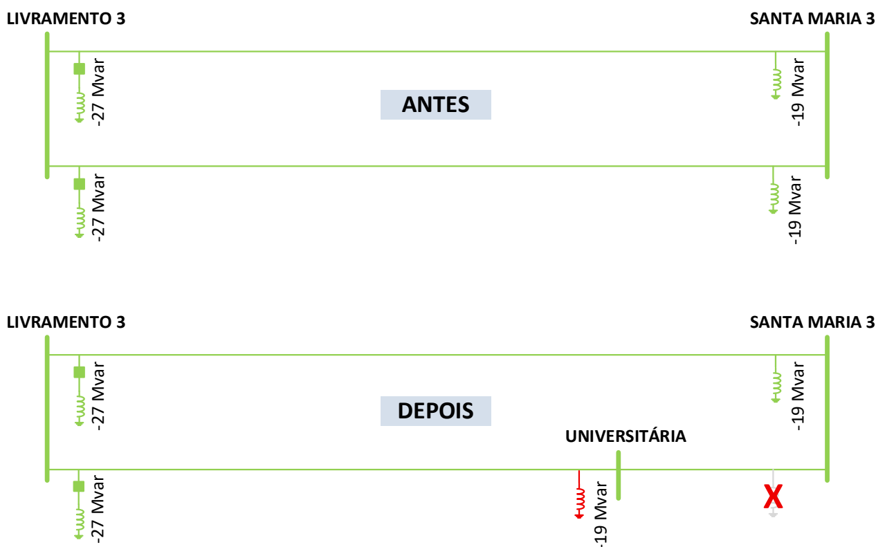
Figura 8-9 Configuração antes e após o seccionamento em Universitária
