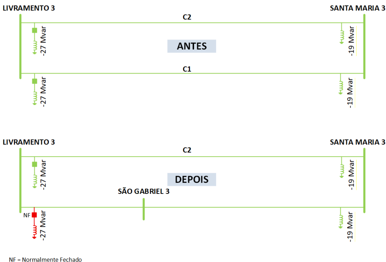
Figura 8-5 Configuração antes e após o seccionamento em São Gabriel 3
