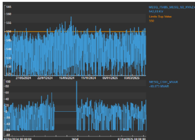
Figura 10 – Perfil de tensão na SE Mesquita 500 kV e uso do CS1 em regime, no período de 07/04/2024 a 07/04/2025.
