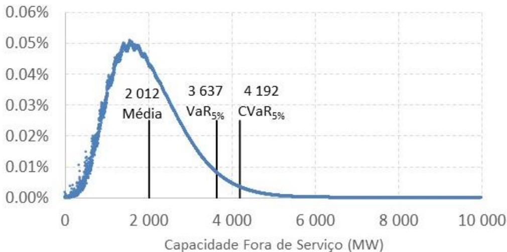
**Figura 53 - Função de probabilidade da capacidade indisponível do bloco termelétrico**
