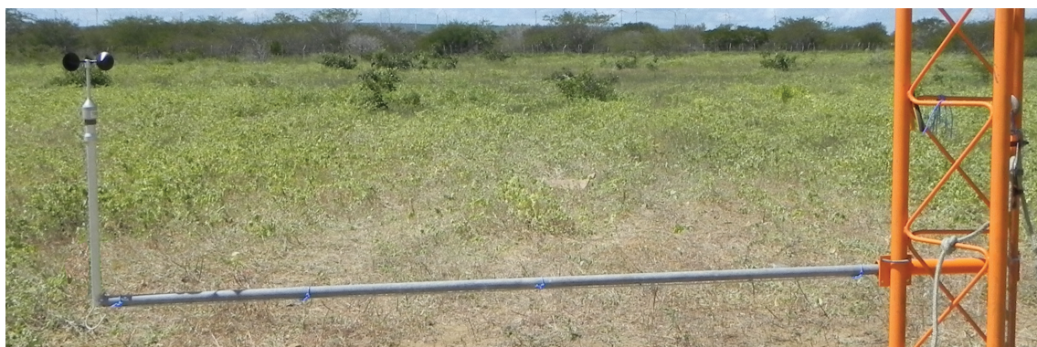
Figura 64. Haste horizontal e vertical montada com um anemômetro.
