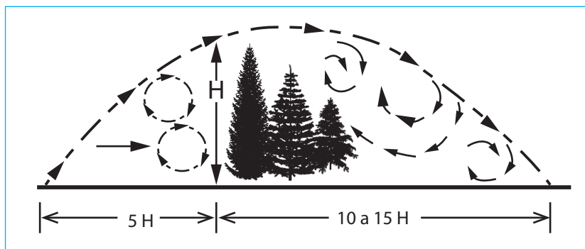
Figura 4b. Zona de turbulência provocada por árvores. Fonte: GASCH, 1993.
