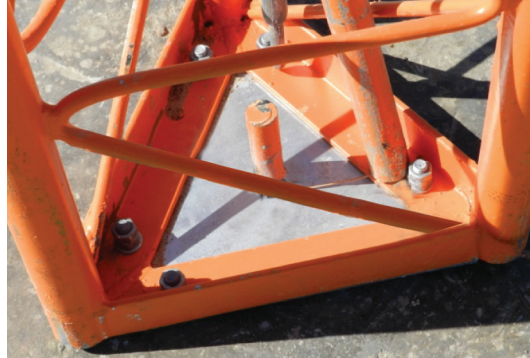
Figura 14b. Fixação do primeiro módulo da torre na base por sistema fixo.
