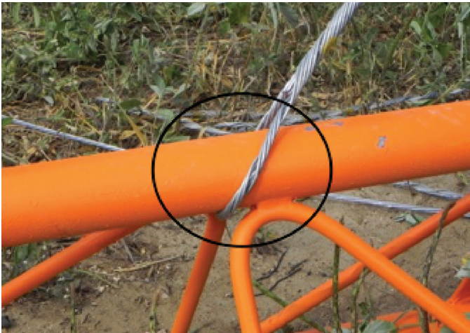
Figura 19. Estai fixado acima do ponto de solda.
