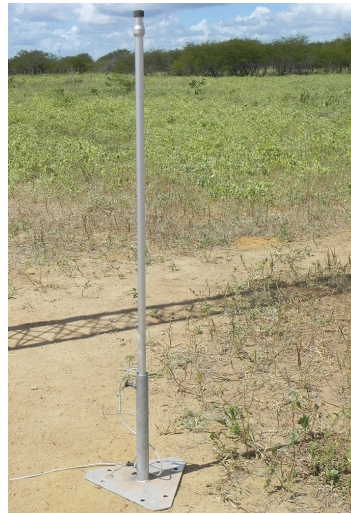
Figura 67b. Base com haste do anemômetro aparafusada.
