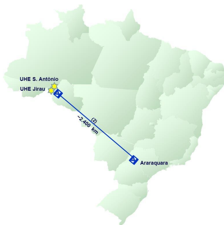
Sistema CCAT \pm 600 kV entre as SE Porto Velho 500 kV e SE Araraquara 500 kV
