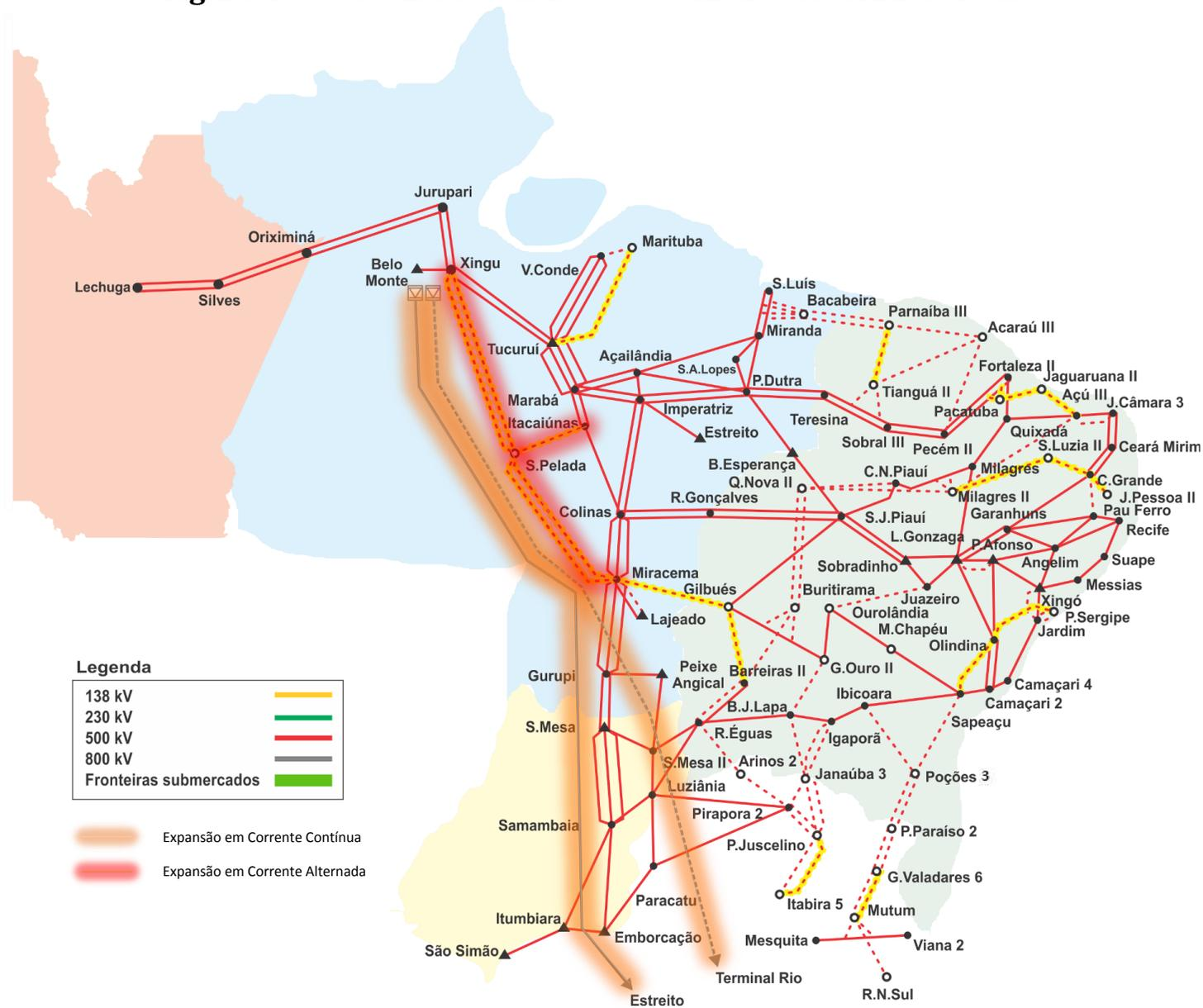
**Figura 4-4.** - Diagrama unifilar simplificado do sistema de transmissão para escoamento das usinas do Rio Teles Pires
