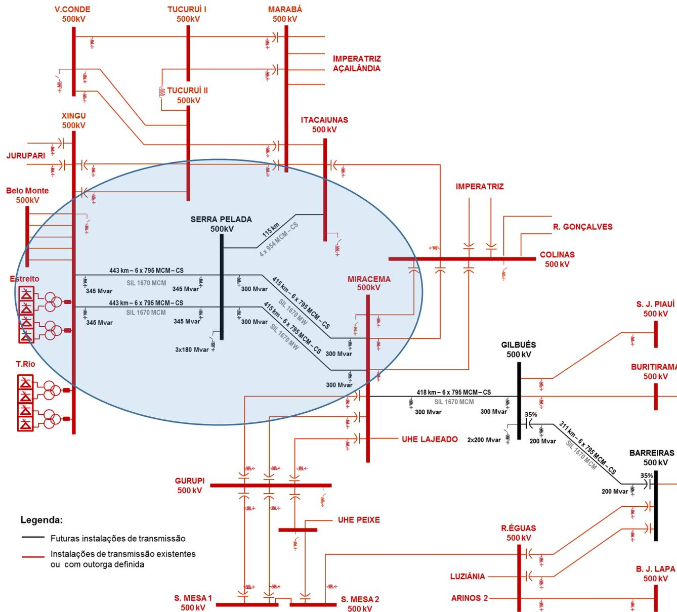
Figura 4-9. – Reforços originalmente indicados para ampliação da Interligação Norte – Nordeste
