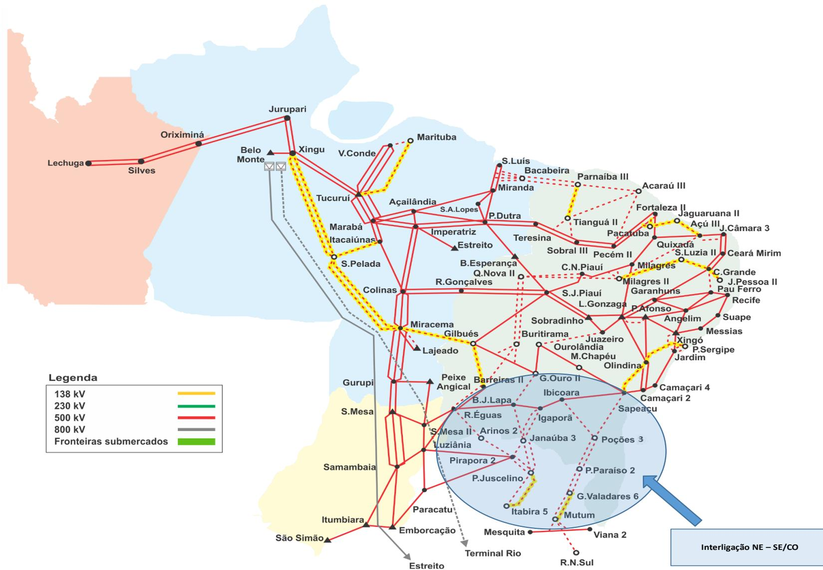
Figura 4-15. – Diagrama esquemático da expansão da interligação Sul - Sudeste/Centro-Oeste
