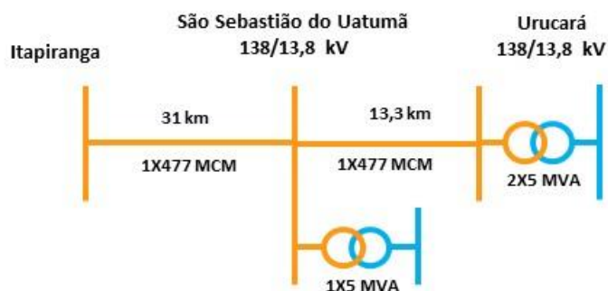
Figura 13 – Diagrama unifilar simplificado LT 138 kV Itapiranga – São Sebastião do Uatumã – Uruará
