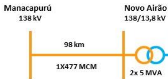
Figura 18 -Diagrama Unifilar Simplificado – LT Manacapuru II – Novo Airão
