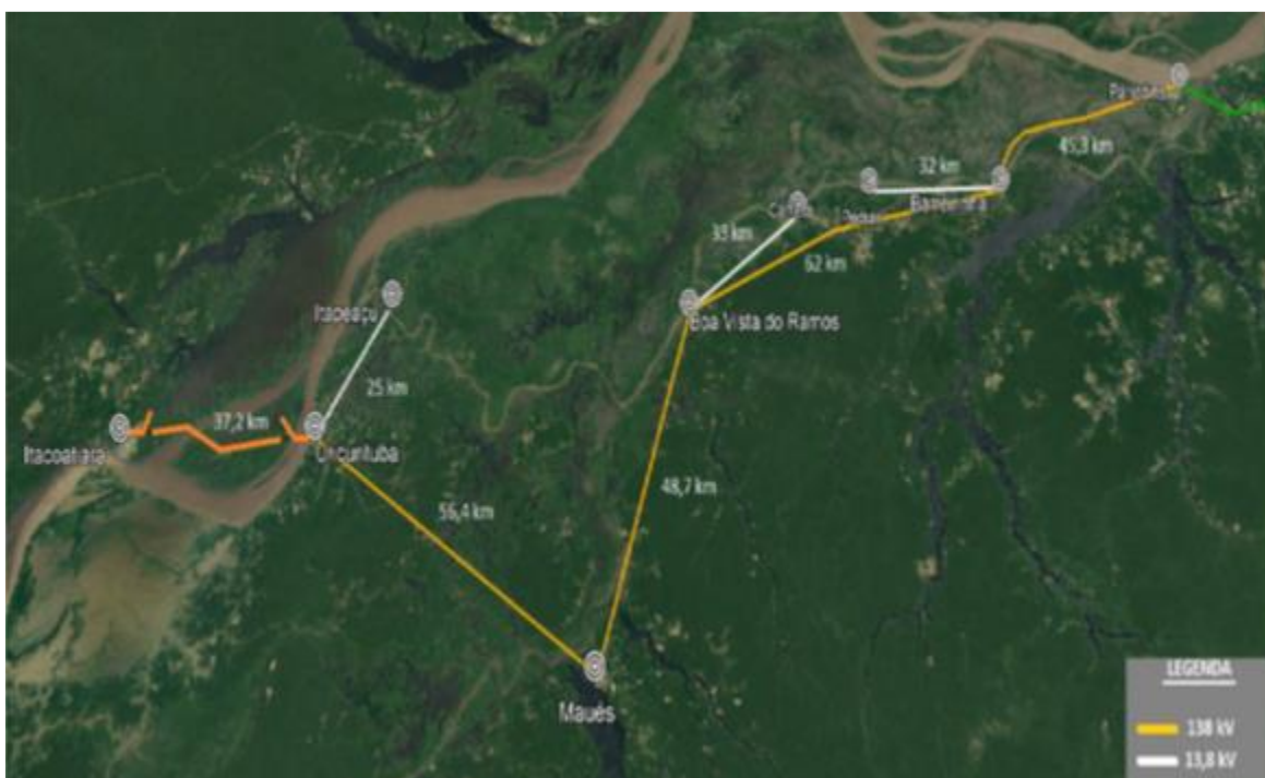
Figura 24 – Trajeto das LTs 138 kV Parintins – Barreirinha - Boa vista do Ramos – Maués – Urucurituba – Itacoatiara (Fonte: AmE)
